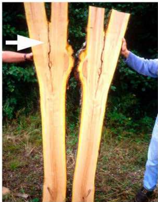
Foto 1- Esempio di ramificazioni codominanti: punto di debolezza strutturale dell'albero.
